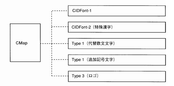
図5:組み替えフォントの作成に使用される CMap ファイル
