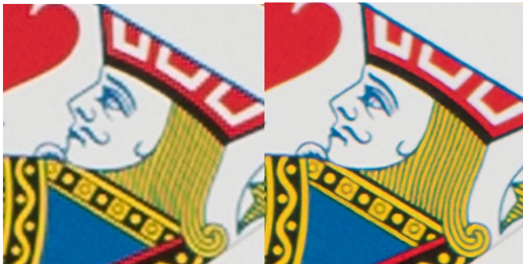
圖四：使用傳統雙立方插值取樣（bicubic resampling）進行放大（圖左）與使用超解析度功能進行放大（圖右）對照
