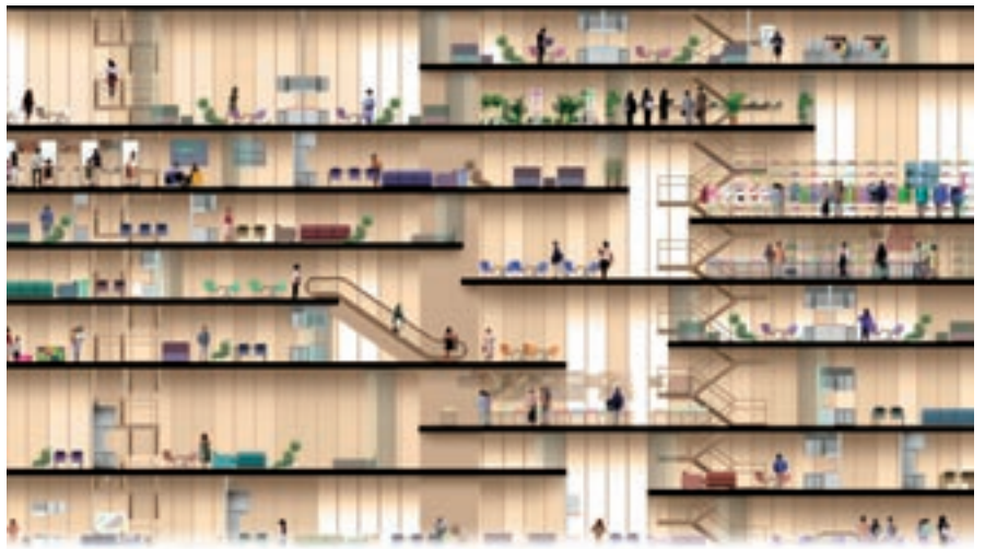
CADで作成した図面をもとに骨格部分をIllustrator上で読み込んで着色を行い、家具や人物を配置していく。最後に仕上げとしてPhotoshopに読み込み、細かな着色や影付けを行うことで、作品としての完成度を上げる
