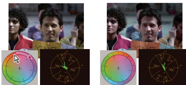
Drehen Sie den äußeren Ring des Farbrads (links), um den Farbtonwinkel (rechts) zu ändern.
