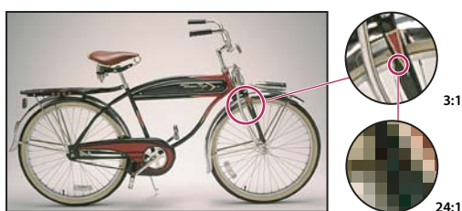
Ejemplo de una imagen de mapa de bits con diferentes niveles de ampliación
