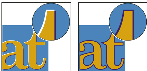
Misspassning utan svällning (vänster) och med svällning (höger)
