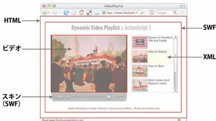
図 A-1 : Flash CS4 Professional で作成されたビデオ再生アプリケーションを構成する様々な要素。このサンプルアプリケーションには、オプションのダイナミック再生リストが装備されています。
