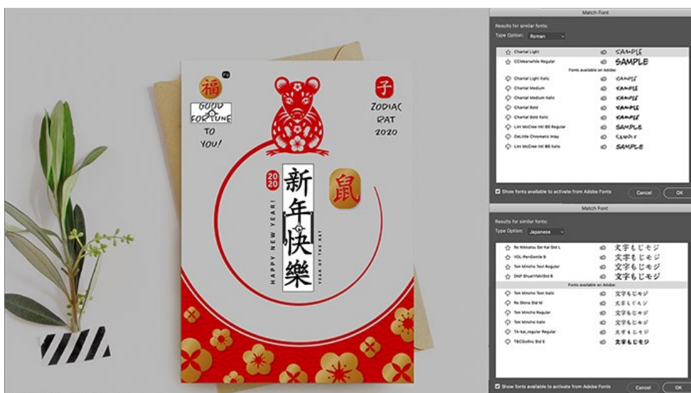
圖 4：演算法將影像中的像素偵測為文字、辨識字體，然後搜尋用戶字體庫以尋找相符的字體。
